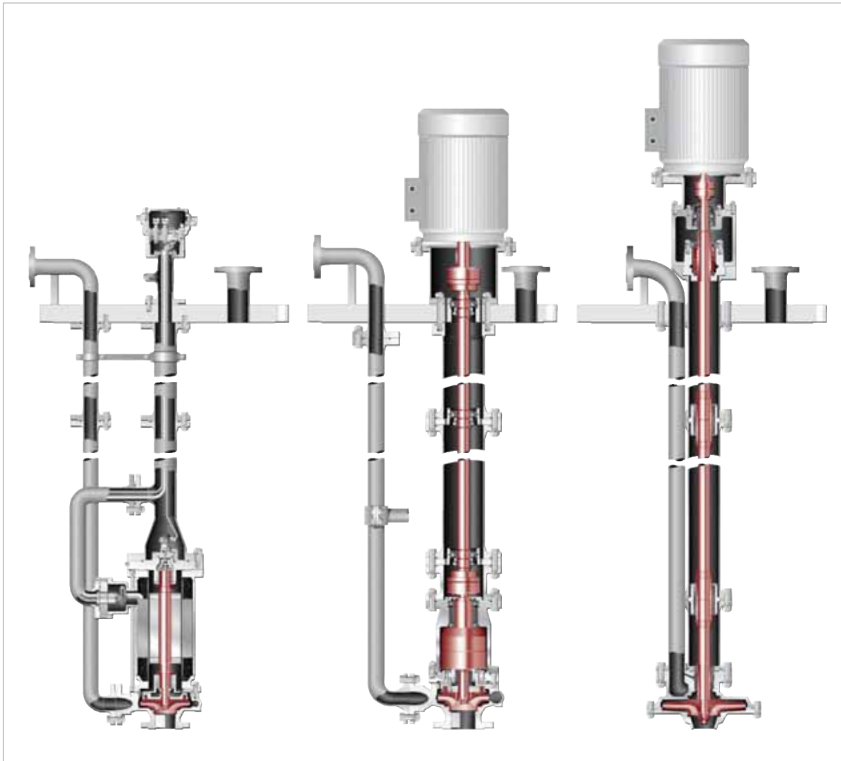
Abbildung 4: Vergleich der drei Tauchpumpen-Bauarten
